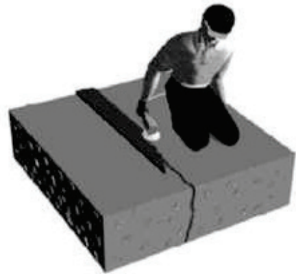
Fig. 6—Remove cap seal.
